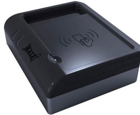
Программатор KD040/90-518 предназначен для локальной записи данных контроля доступа и пользовательских данных на средства идентификации MIFARE® для работы с электронными замками.
